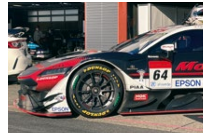
「Modulo Nakajima Racing」の「Honda NSX-GT」に装着したサステナブル原材料比率を高めたレースタイヤ
